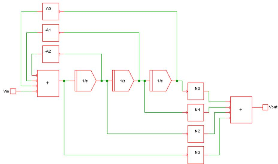
$$V_{out} = V_{in} \cdot (N_3 \cdot s^3 + N_2 \cdot s^2 + N_1 \cdot s + N_0) / (s^3 + D_2 \cdot s^2 + D_1 \cdot s + D_0)$$
